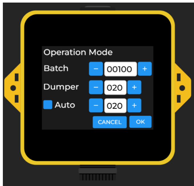
Figura 5 - Edição do Modo Automático (AUTO)
