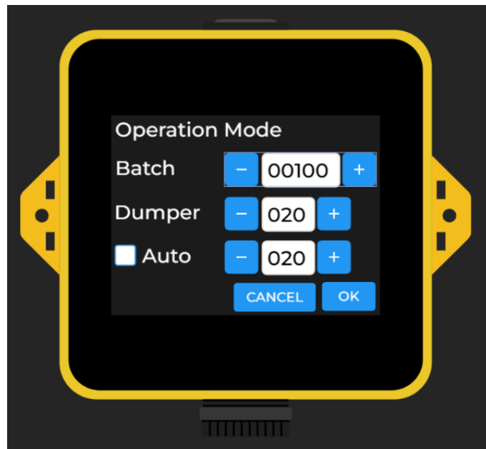
Figura 4 - Edição do Modo Lote (Batch)
